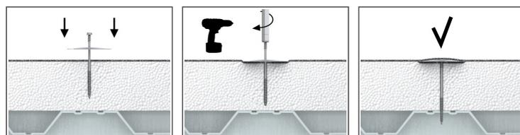
1. Установить шайбу POW на изоляционном материале и использовать соответствующий шуруп
