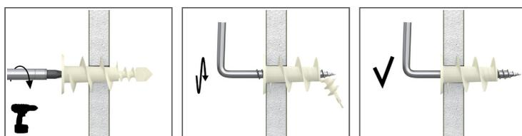
1. Utilizzando un avvitatore PZ2, serrare solidamente il fissaggio sul cartongesso
