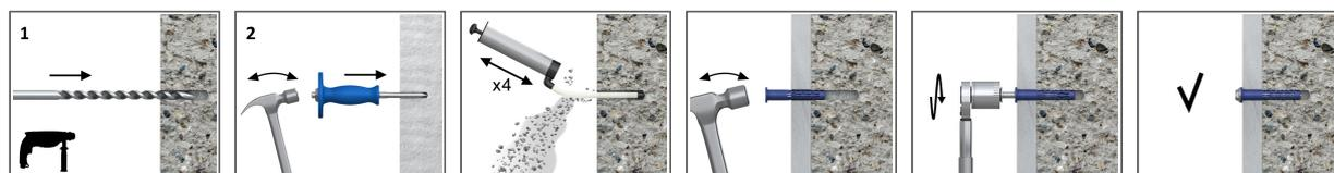
1. Praticare un foro del diametro e della profondità richiesti (figura 1 - materiale di base A,B,C,D) o utilizzare un punzone nel calcestruzzo aerato (figura 2 - materiale di base D)
