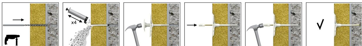
1. Coloque el taco TFIX o KI en el orificio de la placa KWL.
