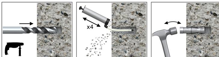
1. Taladre un orificio del diámetro y profundidad requeridos. Nota: En caso de sujeción en ladrillo, evite la fijación en las juntas.
