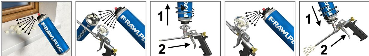
1. Limpieza de la superficie: - Coloque la boquilla pulverizadora adjunta a la válvula de la lata - Pulverice la suciedad fresca con la preparación - Al limpiar la válvula de espuma de poliuretano, rocíe bien la válvula y el adaptador de la pistola - Elimine la suciedad con un paño seco
